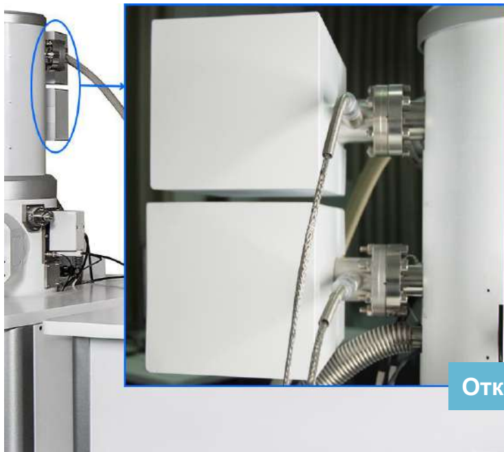
Три молибденовые апертурные диафрагмы объектива Прецизионный механизм выбора и юстировки апертуры
